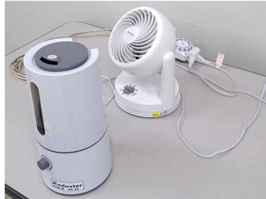
図 5-2 加湿器、サーキュレーター及び自動タイマーの配置例
